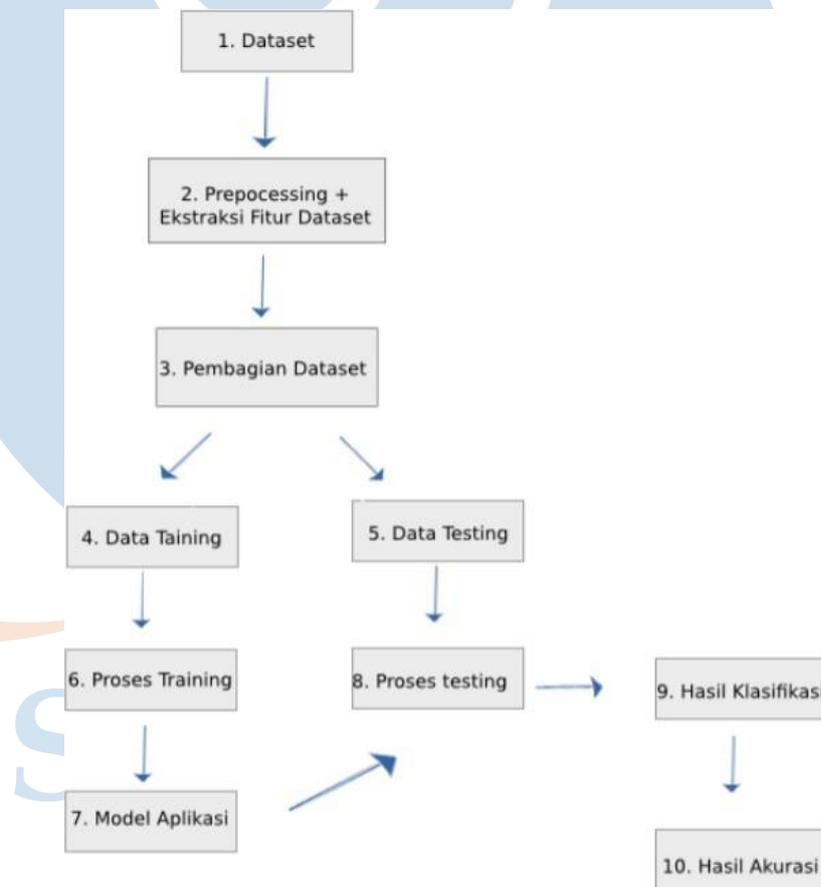
Gambar 2.1.1: Tahapan Pendeteksian Kematangan Buah Melon [5]
